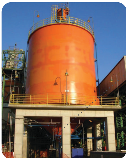
Silo com descarga fluidizada Fluidized discharge silo Silo con descarga fluidizada
