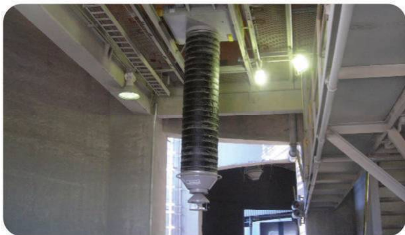
Carregamento móvel de caminhões tanque sob silo. Movable loading of trucks under silo. Cargamento móvil de camiones debajo de silos.
