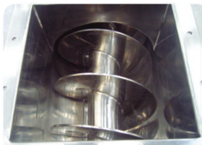
Rosca Inox (Polimento - Grau sanitário) Stainless steel screw / Rosca de acero inoxidable
