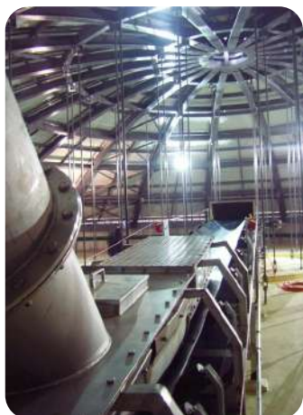
Correia para malte verde Conveying belt for green malt Correa transportadora para malta verde
