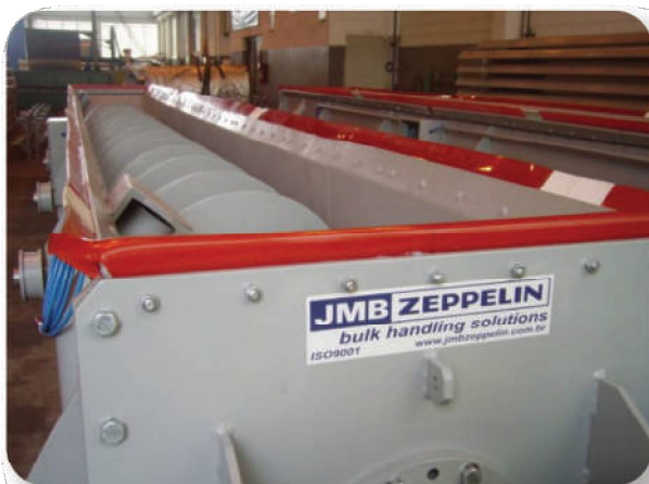
Rosca: aço carbono / Carbon steel screw / Rosca de acero al carbón
