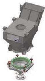
Moega fechada e descarregador vibratório Closed Hopper and vibratory discharger Tolva encerrada y descargador vibratorio
