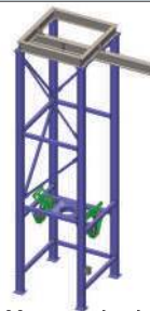
Dispositivo Massageador duplo e perfil de estrutura W Double Massager Device and W profile structure Dispositivo Masaieador duplo con perfil W
