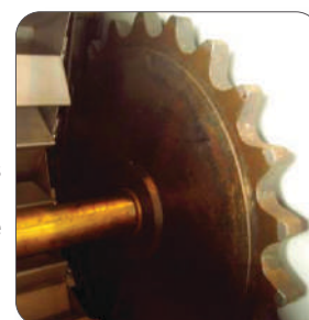
Engrenagem do elevador de canecas por correntes Buckets elevator gear by chain Engrenaje del elevador de cangilones por corriente
