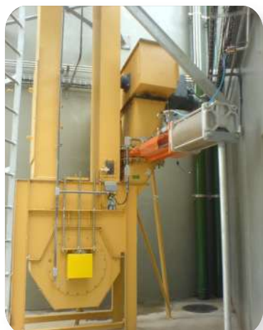
Pé com baixo volume de resíduo Bucket elevator foot with low waste volume Pie elevador de cangilones con bajo volumen de residuos
