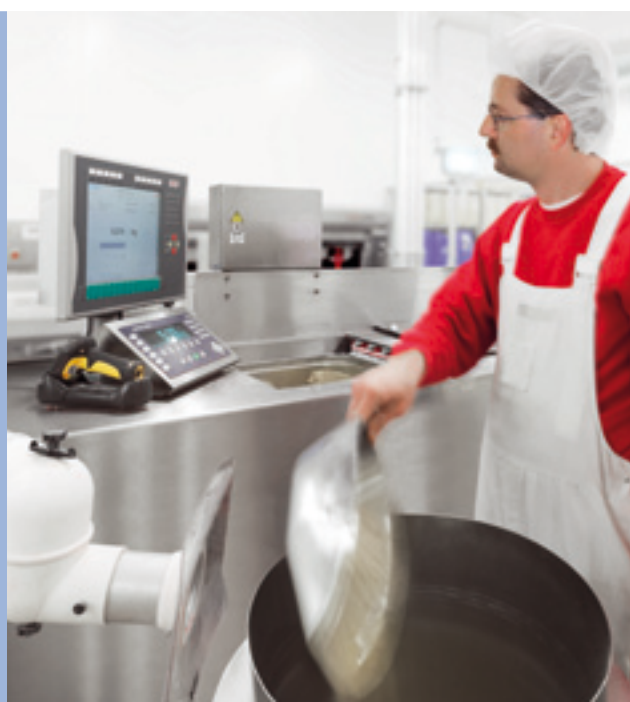
Medição registrada de ingredientes adicionados manualmente
