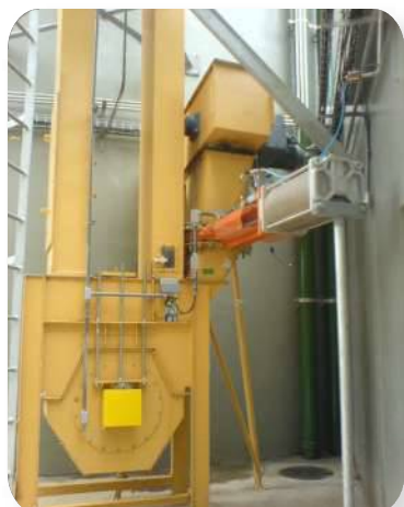
Pé com baixo volume de residuo Bucket elevator foot with low waste volume Pie elevador de cangilones con bajo volumen de residuos
