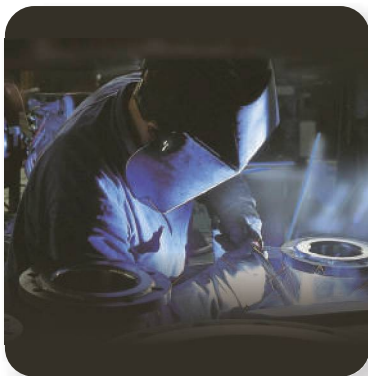
Soldagem de vaso de pressão na planta da Zeppelin Systems Welding on pressure vessel at Zeppelin System's plant Soldadura de estanque de presión en la fábrica de Zeppelin Systems
