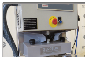
Duplo Acionamento (Segurança) Two-Hand Control Accionamiento a dos manos
